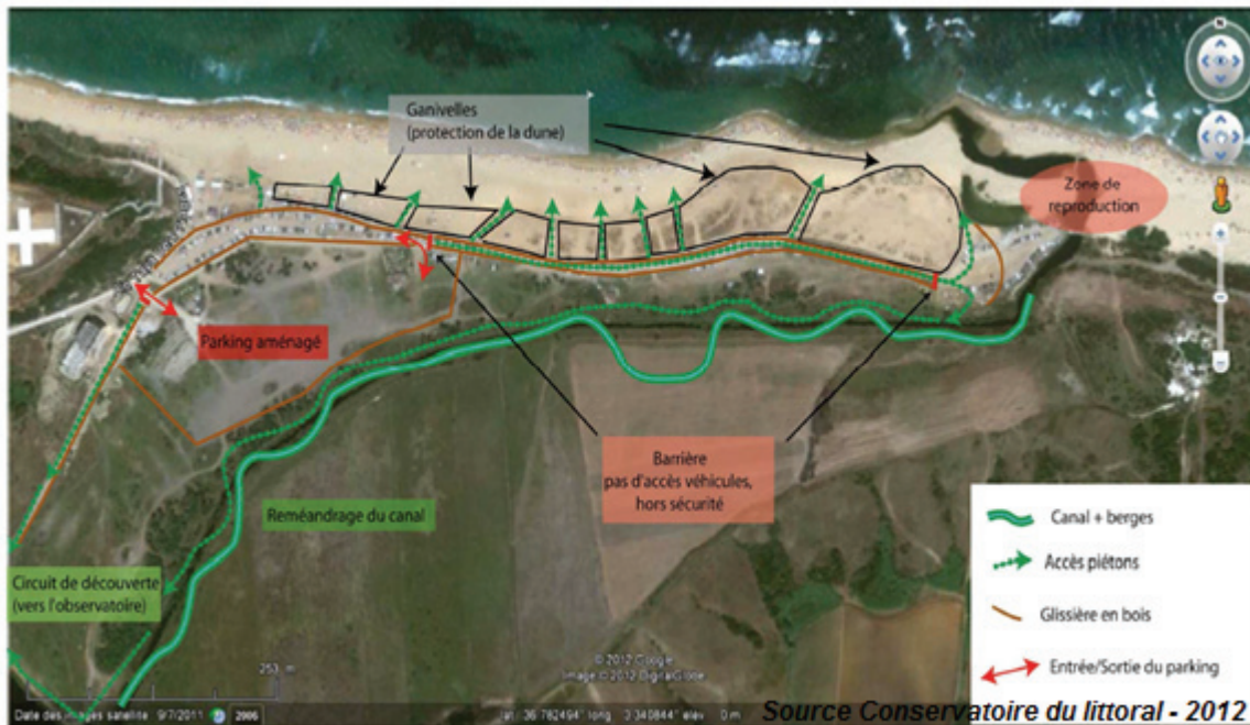
Figure 3 : Mesures préconisées pour la réhabilitation et valorisation du cordon dunaire du site Kadouss
